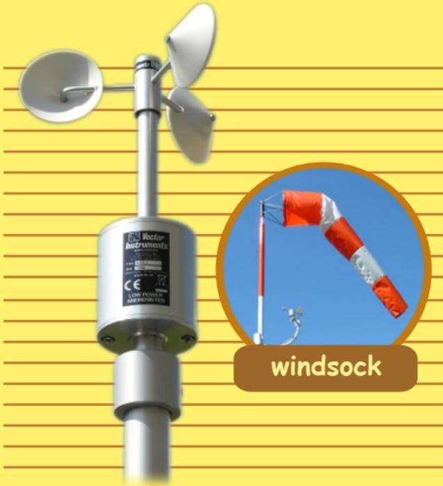
**Anemometer** adalah sebuah perangkat yang digunakan untuk mengukur kecepatan angin. Sedangkan untuk mengukur arah angin digunakan alat *windvane* dan *windsock* yang bisa terpasang menyatu atau terpisah dengan anemometer.
