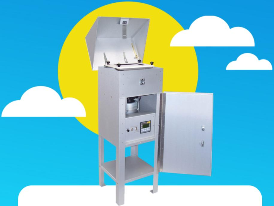
Alat *High Volume Air Sampler (HVAS)* mempunyai prinsip kerja dimana udara mengandung partikel debu dihisap melalui kertas filter menggunakan motor dengan putaran kecepatan tertentu.
